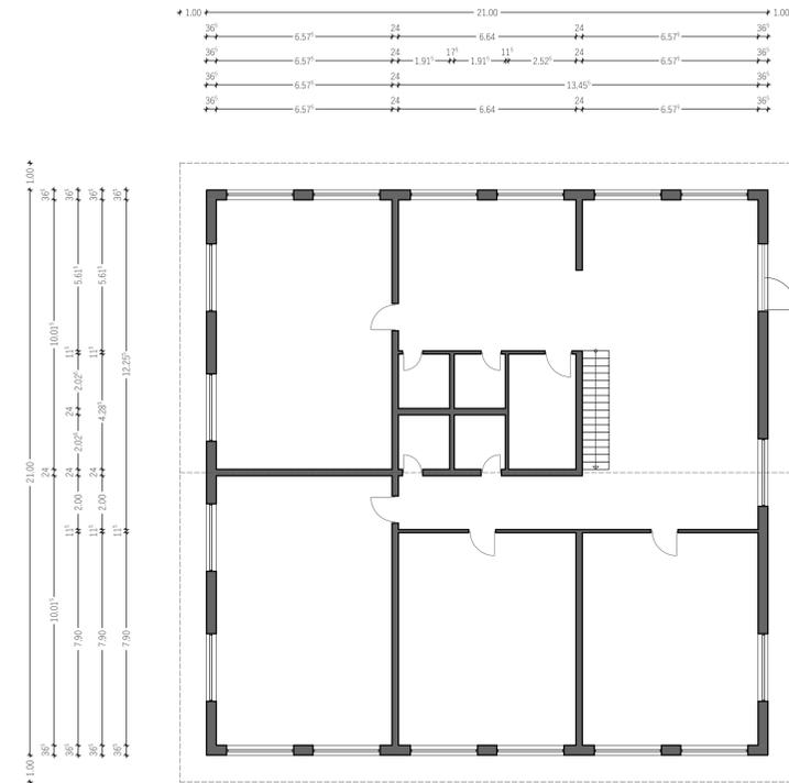
Grundriss Erdgeschoss Bürogebäude Süd M 1\_100
